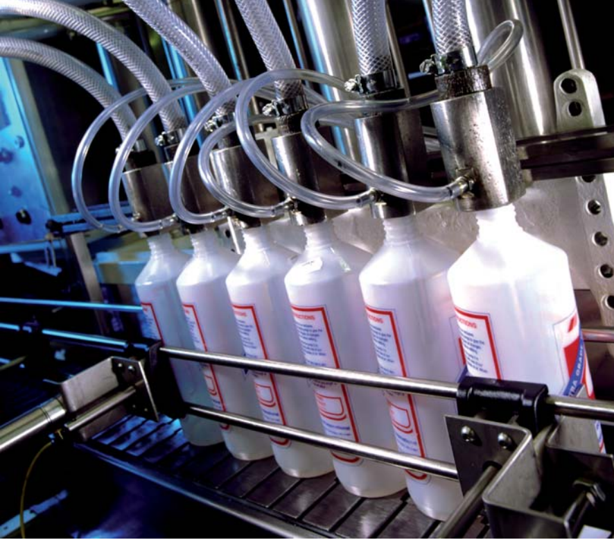
Sistem maliyetini düşüren Mitsubishi MR-E servo sistemleriyle donatılmış doldurma makineleri
